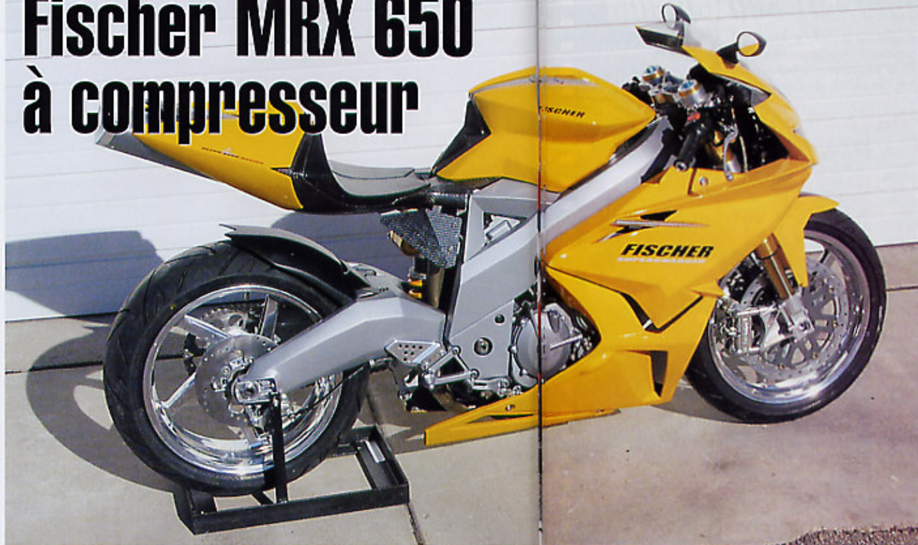
La Fischer MRX 1000 s'est muée en MRX 650. Sous une carrosserie acérée se cache désormais un V-twin Hyosung de 650 cm 3 boosté par un compresseur.
