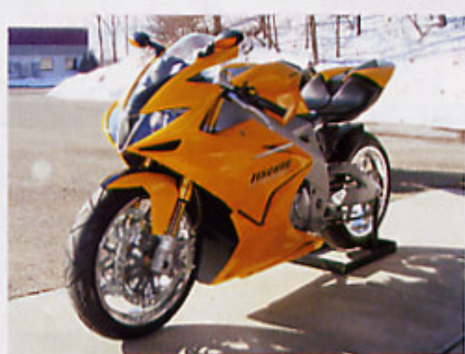
La Fischer MRX 1000 s'est muée en MRX 650. Sous une carrosserie acérée se cache désormais un V-twin Hyosung de 650 cm 3 boosté par un compresseur.
